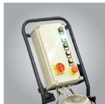
▶ Operação através de painel de controlo móvel
